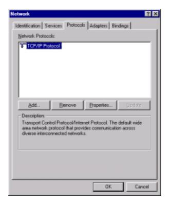
2. В окне Network-Protocols выбирается TCP/IP Protocol и нажимается кнопка Properties... Выводится следующее:
