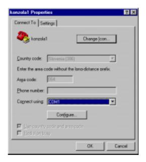
2. На МТ выбирается тот последовательный порт (COM1 или COM2), к которому подключили кабель консоли. Для установки других параметров консоли открывается новое окно с помощью кнопки Configure в вышеуказанном окне. Открывается нижнее окно, в котором имеются соответствующие параметры консоли:
