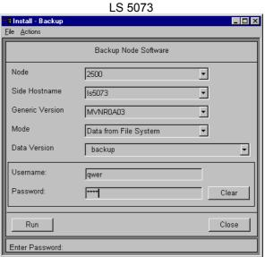
2. С помощью кнопки "Run" запускается передача данных из станции в MN. Открывается окно, в котором с помощью "Yes" подтверждается передача данных. Сообщение о завершении процедуры следующее: »Backup done«. С помощью »Yes« дается ответ на: »Do you wish to view log file?«, затем выполняется просмотр файла, содержащего все архивные данные о передаче.
